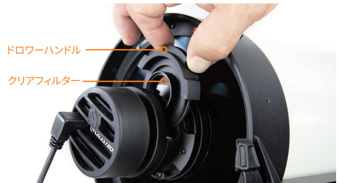
図 15：ドロワーハンドルを指でしっかりつかみ、手前に引いてマグネットから取り外してください。
