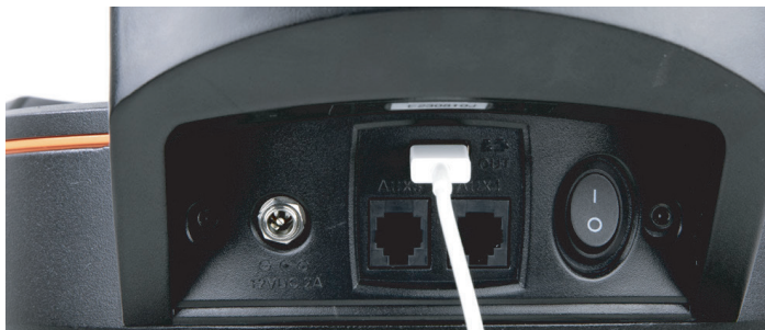
図38: Origin架台のUSB充電ポートは、観測地でお使いのデバイス（スマートフォンなど）を充電するために使用できます。
