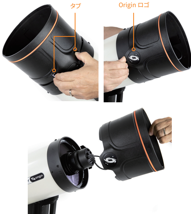
図 13：レンズフードの取り外し方。Origin ロゴの下を上向きに押しつつ、片手で 2 つのタブを押し下げてフードを取り外してください。
