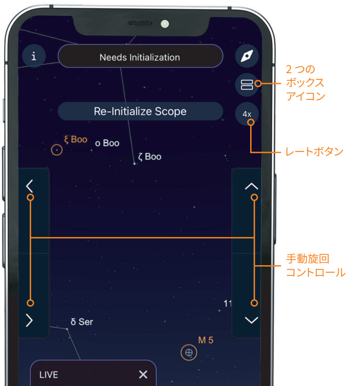
図 24：望遠鏡コントロールの表示はプラネタリウム画面に表示される手動旋回コントロールアイコンです。上下左右の方向ボタンで望遠鏡を旋回させ、レートボタンで旋回スピードを変更します。
