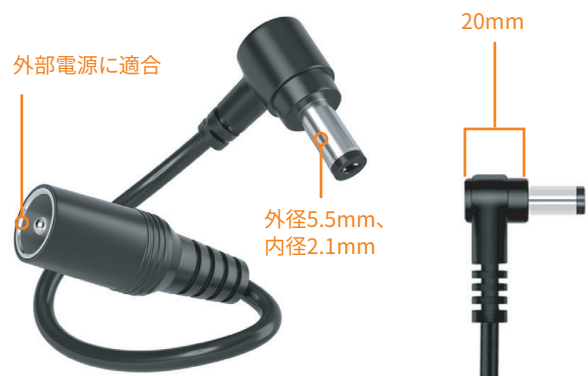
図D5:赤道儀ウェッジモードで外部電源を使用する際に、緯度35度以上の場所で発生しやすい電源プラグの挟み込みを防ぐため、直角アダプターの使用を推奨します。推奨アダプターの仕様高さは20 mm以下プラグ仕様で、外径5.5mm、内径2.1mmのDCプラグです。
