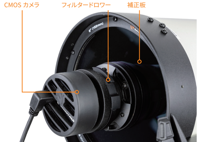
図 14：フィルタードロワーはカメラと補正板の間にあります。
