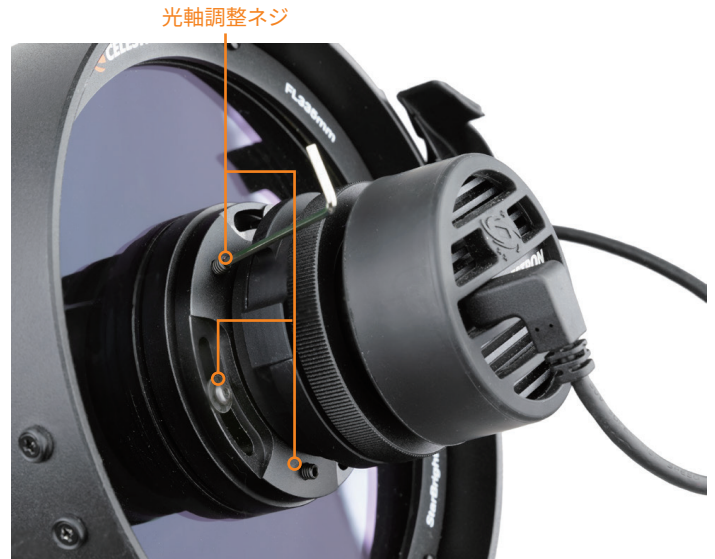
図 34：この光軸調整ネジを使用して、レンズ群(およびカメラ)の傾き(チルト)を調整してください。
