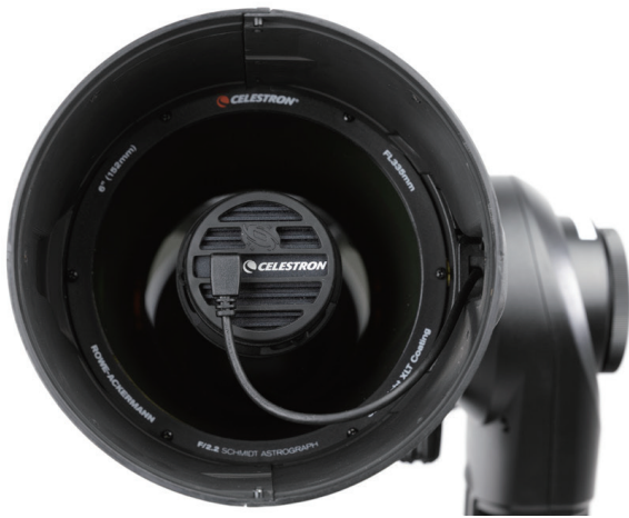
図 29：工場で撮像され、Origin にプリロードされているフラットフレームは、カメラが図に示す向きで撮像されたものです。この向きからカメラを回転させた場合、必ず新しいフラットフレームを作成する必要があります。
