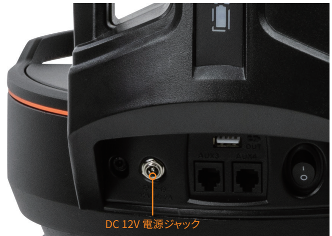
図 1 : 付属の AC アダプターのプラグを、Origin 架台底部にある DC 12V 電源ジャックに差し込んでください。
