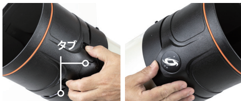
図 1：Origin ロゴの下を押し上げながら、2 つのタブを押し下げて対物フードを取り外す
