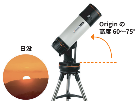
図 10：「スカイフラット」撮像時の Origin の配置 ※日没後、約 20～30 分経ってから行う
