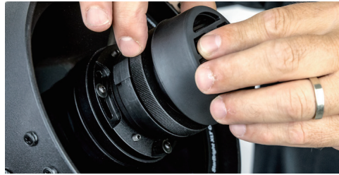
図 2：Origin-178C カメラを取り外すため、固定リングを緩める
