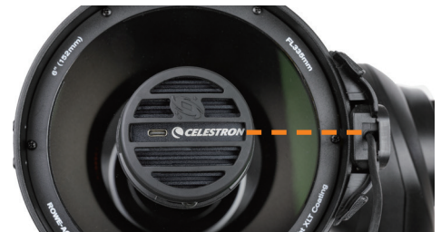
図 9：カメラ前面の Celestron ロゴとセンサーが平行になる向きにカメラを設置
