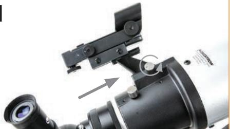
スター・ポインターファインダーのブラケットをアリミゾ式ファインダー台座に接眼部の後ろからスライドさせます。スター・ポインターファインダーの丸いウインドウが鏡筒の先端方向に向けます。固定ネジを締めて、スター・ポインターファインダーのブラケットを固定します。
