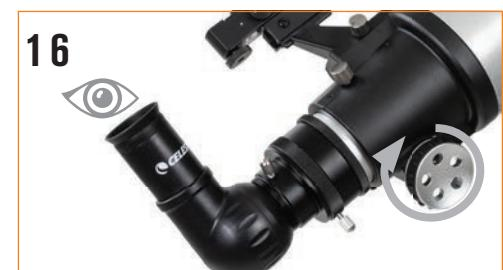
望遠鏡の前面からキャップを取り外します。観察するには、図の $\circlearrowleft$ の位置から接眼レンズを覗きます。接眼部の下にあるピント調節ノブを回してピントを合わせます。
