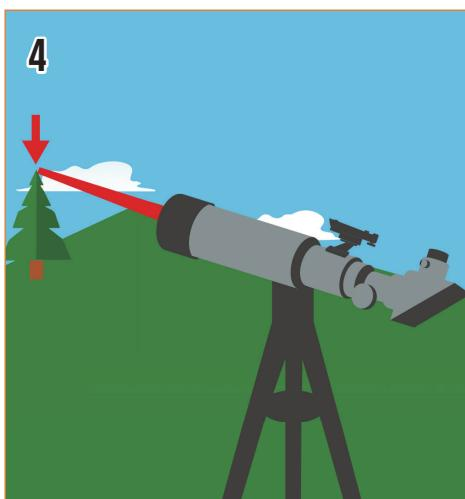
次に、スマートフォンの画像と望遠鏡の視野に見える対象物を合わせます。望遠鏡を最低でも 500m 以上離れたできるだけ遠くの対象物に向けます。
