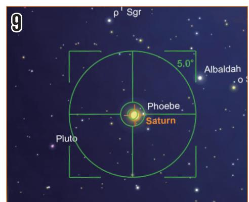
目標の星をターゲットマーカーの中心に導入して数秒待ち、ターゲットマーカーが緑色になると、天体が正常に導入されたことを表します。望遠鏡の接眼レンズを覗くと接眼レンズの視野内に目標天体を見ることができます。
