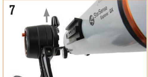
アリミゾホルダーの鏡筒固定ネジが上を向くように上下微動ハンドルを回します。鏡筒固定ネジを緩め、鏡筒のアリガタレールがアリミゾホルダーから浮かないように、前面からスライドさせます。
