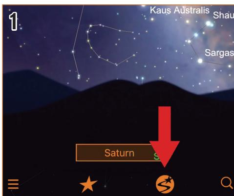
アプリを起動し、StarSenseアイコン(点滅)をタップすると「スマートフォンと望遠鏡の同期はできましたか?」と表示されます。望遠鏡との同期が完了していれば「同期作業は完了しています」を選択します。同期を行っていない場合やスマートフォンを一度でも外した場合は、「同期作業は完了していません」を選択し、同期作業を行います。同期が完了したら、肉眼で星が確認できる方向に望遠鏡を向け、アプリが星空と同期するまで、お待ちください。アプリの中心部の赤いターゲットが黄色に変われば同期が完了です。月が明るい日は、月明かりの入らない方向に望遠鏡を向けるか、月のない夜にお使いください。
