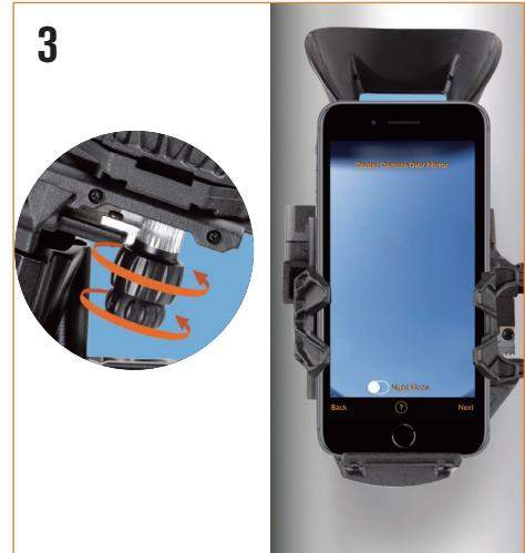
StarSense Explorer アプリの画面で、スマートフォンのカメラ画像が表示されたら、StarSense Explorer スマートフォンドック下部のノブを回してカメラ画像が画面全体に見えるように調整します。画面の上下左右に黒い影(ケラレ)が表示される場合は黒い影が上下、左右同じく見えるように調整してください。
