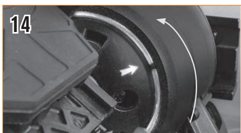
StarSense スマートフォンドックの矢印を経緯台の取り付け位置マークに合わせ、オレンジ色の取り外しボタンが StarSense スマートフォンドックの穴にカチッと音がして収まるまで反時計回りに回しながら内側に押してください。
