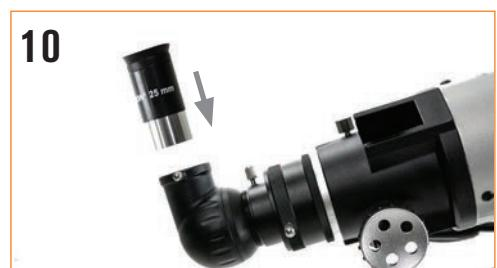
接眼レンズを取付けます。正立天頂プリズムの固定ネジを緩めて接眼レンズを正立天頂プリズムに差込み、固定ネジを締めます。まず最初に低倍率の接眼レンズ(25mm)を使用して、ターゲットを導入します。その後、必要に応じて高倍率の接眼レンズ(10mm)に取替えます。
