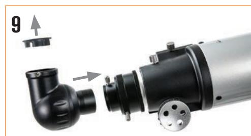
正立天頂プリズムを取付けます。接眼部の固定ネジを緩め、ダストキャップを外します。また、正立天頂プリズムの両側からキャップを外します。
