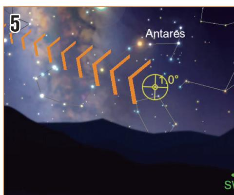
中心の黄色い円(ターゲットマーカー)は望遠鏡が向いている方向を示し、矢印は望遠鏡を動かす方向を示しています。
