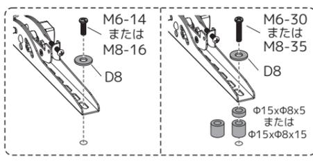
取り付けるモニター / サイネージのサイズや形状によって使用するネジの径と長さが異なります。ご使用のモニターに合わせてネジを選択し、金属、樹脂ワッシャーでネジの深さを調節した上で、モニターに VESA 金具を取り付けてください。
