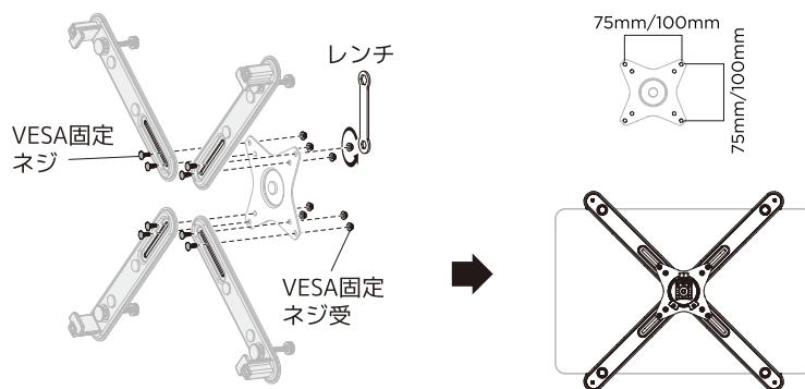
1. で組み立てた部品を75x75/100x100のVESA金具と上図を参照に組み合わせてください。
