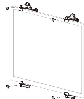
組み立て完了後は左図を参照にホルダーカバーを取り付けてください。
