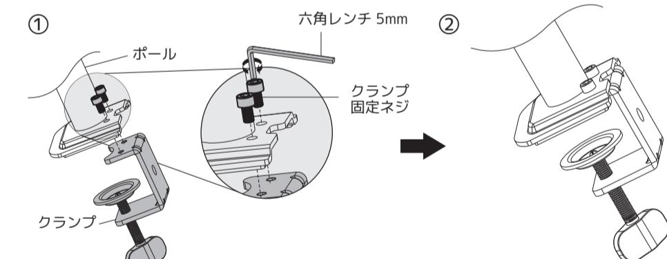
①上図を参照に六角レンチ 5mm を使って、ポールとクランプをクランプ固定ネジで固定してください。
