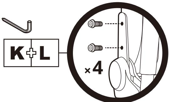
左右4つのネジを一度手でゆるく仮止めした後、六角レンチでしっかりと締めてください。
