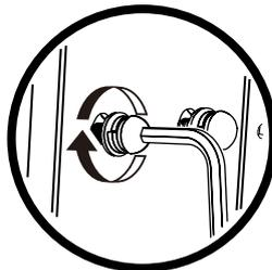
8割くらいに仮締めしたネジを、六角レンチで締めてください。スプリングワッシャーの隙間がなくなるまで、しっかりと締めてください。
