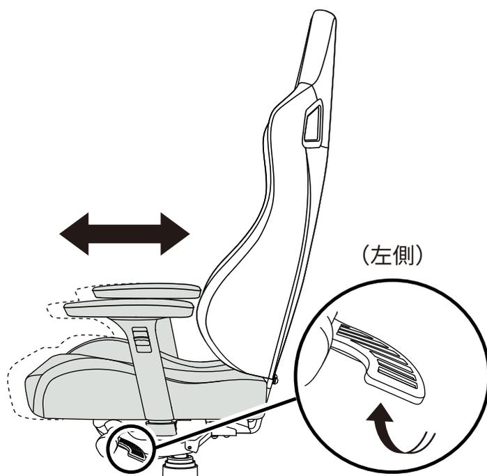
レバーを上へ引きながら、座面を前後に動かし、お好みの位置でレバーを離します。腰を浮かせた状態でレバーを引くと、座面が一番奥に戻ります。
