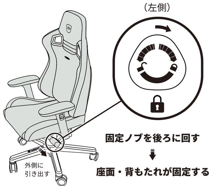
座面はお好みの角度に固定できます。固定を解除する際はロック固定ノブを前に回し、背もたれを後ろに押し込むと、「カチっ」と音が鳴り座面の角度が平行に戻ります。
