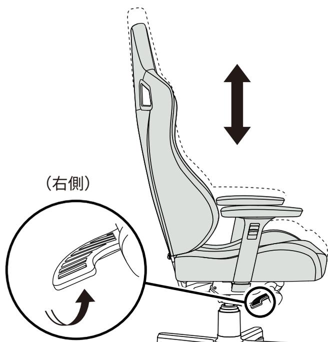
座面の高さを上げたい時は、腰を浮かせた状態で座面右側のレバーを上へ引いてください。レバー自体は完全に固定されず、緩くなっています。
