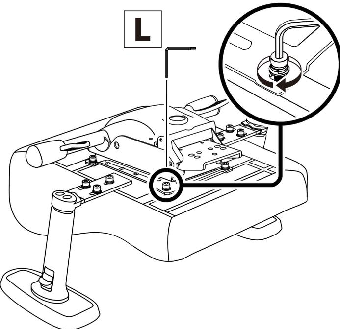
8割くらいに仮締めしたネジを、六角レンチで締めてください。スプリングワッシャーの隙間がなくなるまで、しっかりと締めてください。
