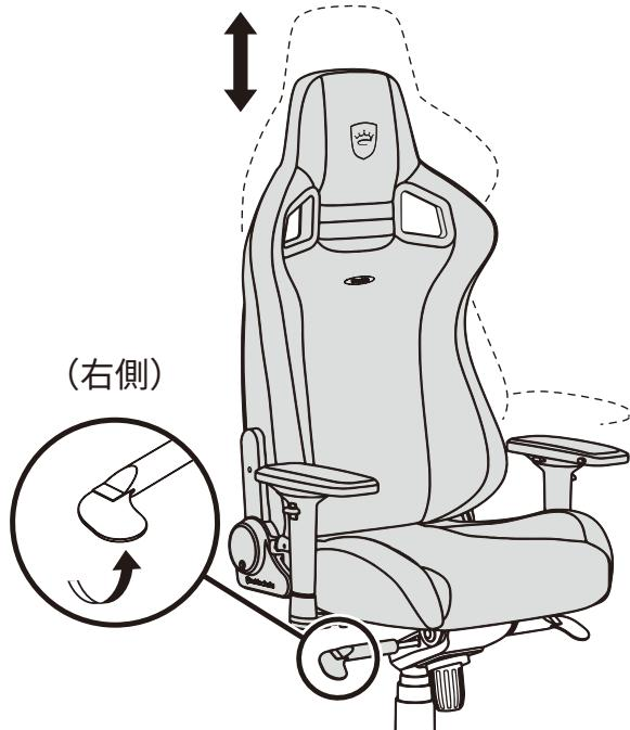
座面の高さを上げたい時は、腰を浮かせた状態で座面右側のレバーを上に引いてください。
