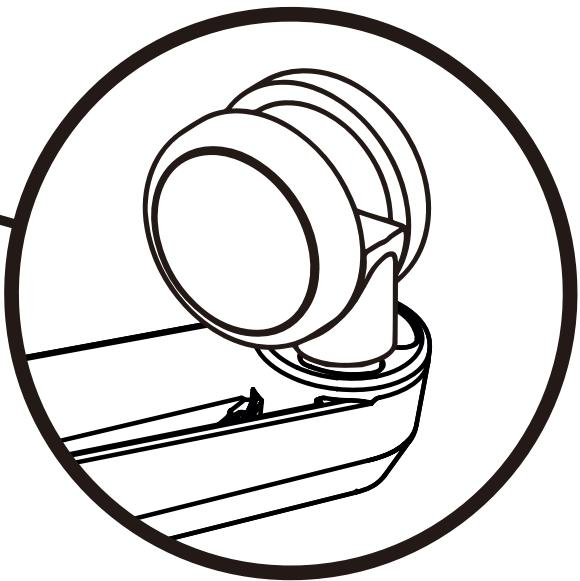
脱落防止のため、シルバーの軸が完全に隠れるまで押し込んでください。両手でひとつずつ確実に入れてください。
