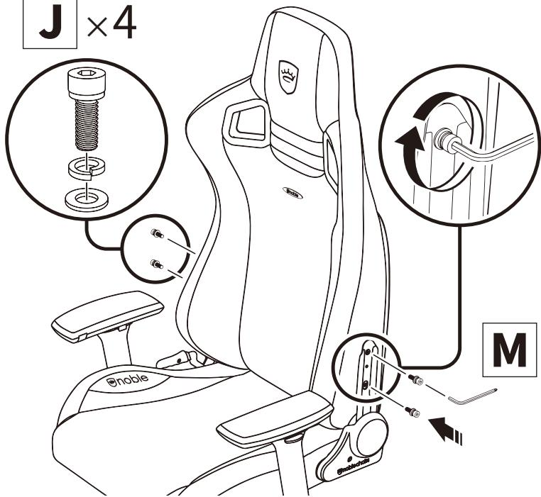
必ずリクライニングレバー側からネジを取り付けてください。7番で外したネジを使用します。
