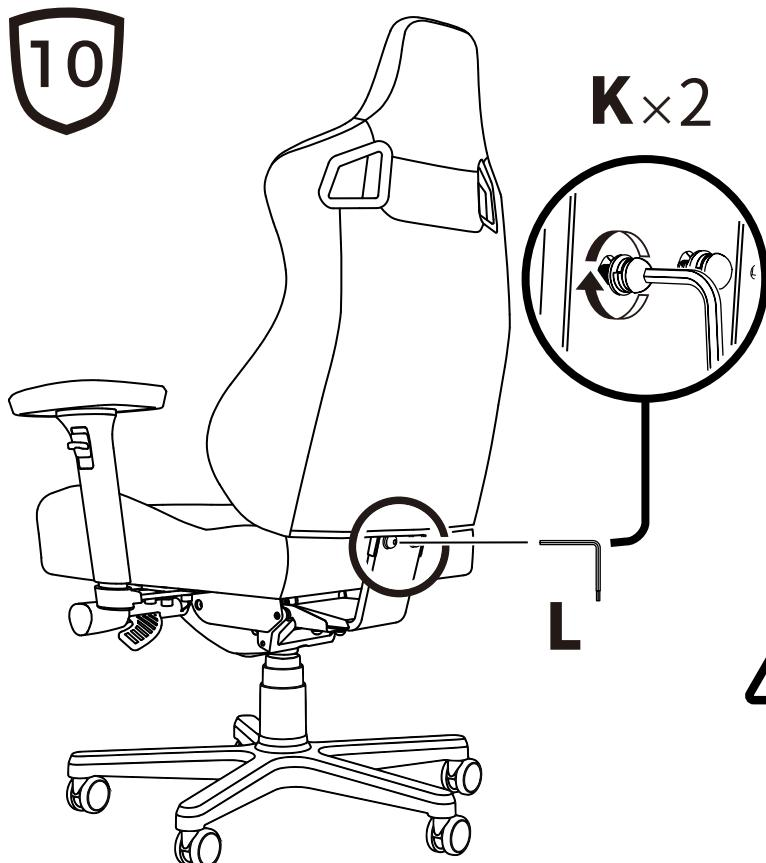
8割くらいに仮締めしたネジを、六角レンチで締めてください。スプリングワッシャーの隙間がなくなるまで、しっかりと締めてください。
