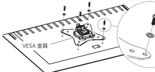
**⚠️** ワッシャーを使用しない、もしくは使用してもネジを締めすぎた場合、モニタのVESA穴を破損する恐れがあります。
