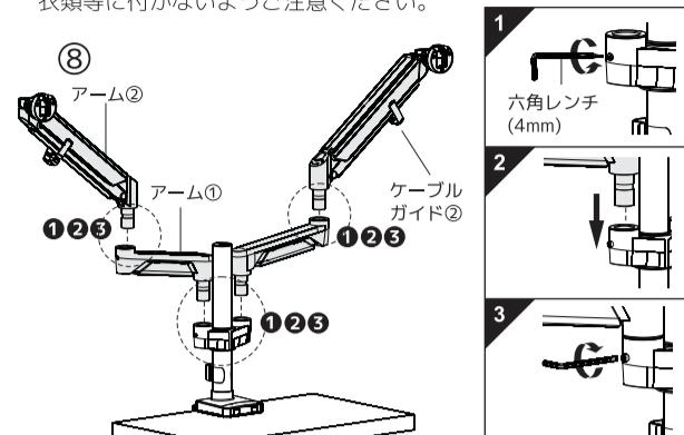
⑧ 固定が完了したらアーム①→アーム②→ケーブルガイド②の順に取り付け、接続部分のネジを六角レンチ（4mm）で締めて抜けないよう固定してください。
