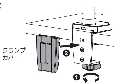
⑥ クランプ部分を机に挟んだら、クランプパーツ①の下の部品（左図の①の部品）を回して机に固定してください。固定が完了したらクランプカバーを取り付けてください。
