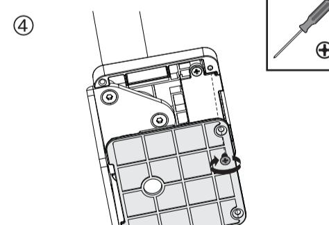
④ ①で取り外した滑り止めゴムを戻し、M4-8mm ネジで固定してください。
