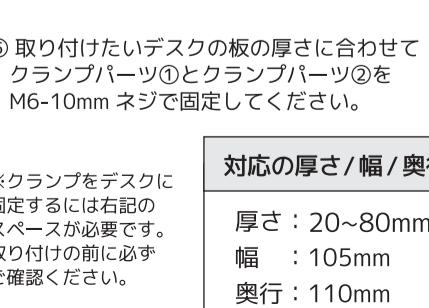
⑤ 取り付けたいデスクの板の厚さに合わせてクランプパート①とクランプパート②を M6-10mm ネジで固定してください。
