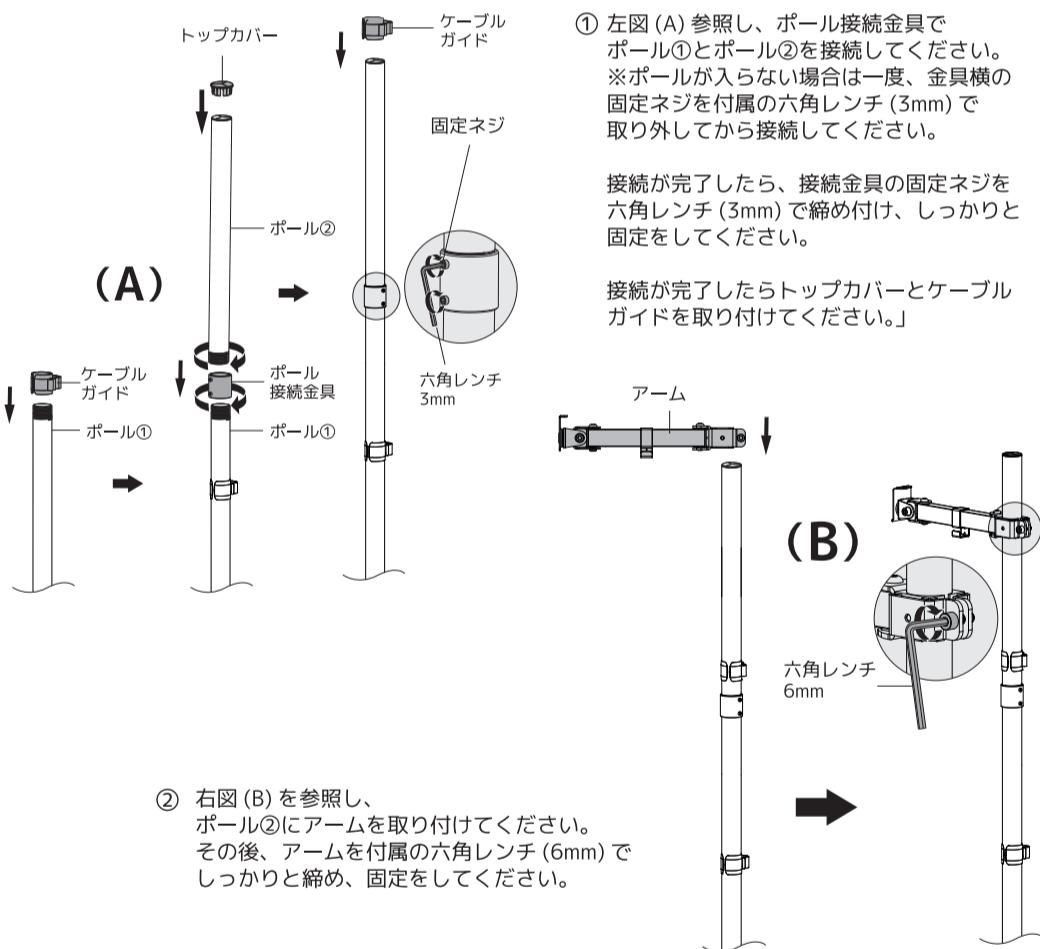
② 右図 (B) を参照し、ポール②にアームを取り付けてください。その後、アームを付属の六角レンチ (6mm) でしっかりと締め、固定をしてください。
