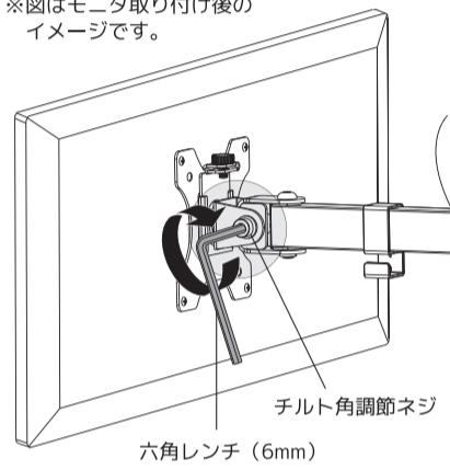
・本製品は左図のチルト角調節ネジのみ調節が可能です。(モニタを支える部分です。基本的には締める形になります)
