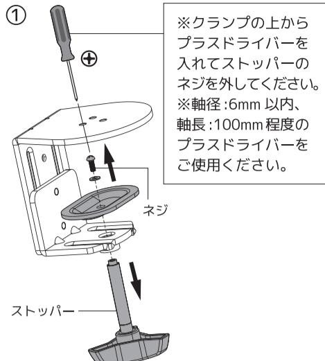
①グロメット方式で固定する場合、クランプから一部共用部品を取り外す必要があります。上図の通り、クランプからネジを外し、ストッパーを取り外してください。
