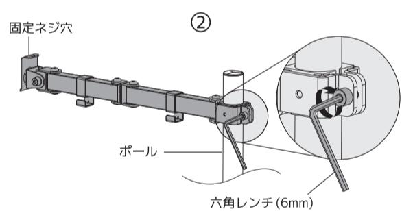
②固定したい位置にアームを移動させたら、付属の六角レンチ(6mm)でアームの固定ネジを締め付け、固定してください。(時計回りで締め付け)
