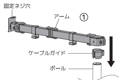
①ケーブルガイドをポールに挿し込み、固定ネジ穴が上側に向いた状態で、アームをポールに挿し込んでください。
